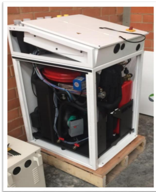
Figura 34 Instalación bomba calor geotérmica proyecto Piloto Parque Industrial la Gran Sabana. [46]
