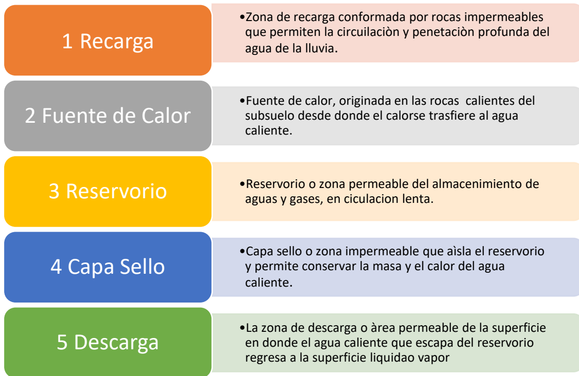
Figura 17 Elementos que definen un campo Geotérmico Convencional. [23]
