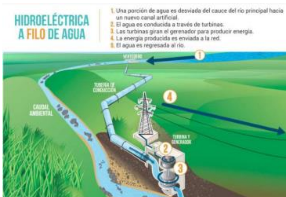
Figura 72. Hidroeléctrica a filo de agua. Fuente: UPME (2017). [8]
