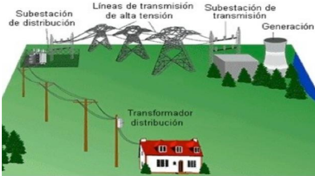
Figura 1 Sistema eléctrico con centros de producción y de consumo de energía eléctrica. Fuente: Rincón Eléctrico [1].
