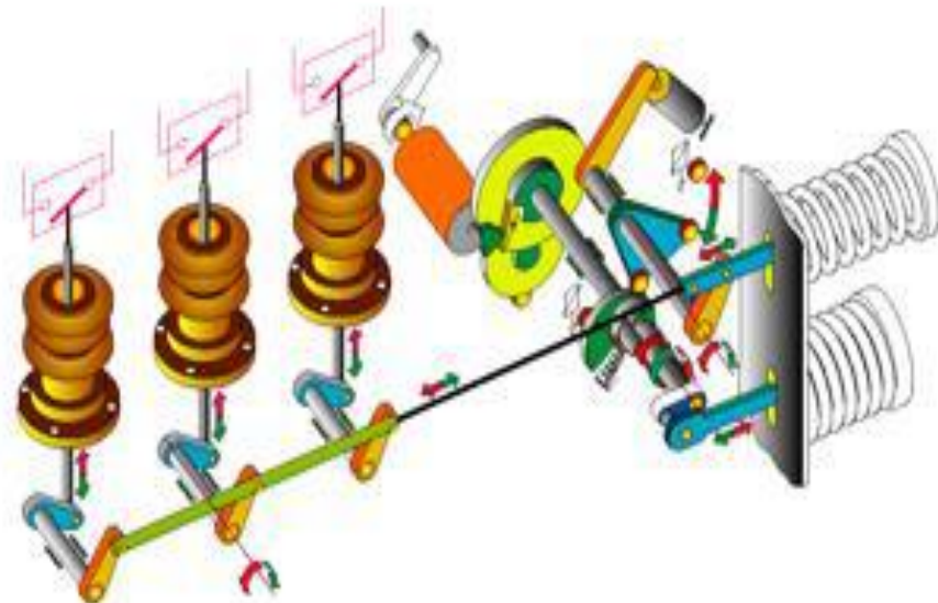
Figura 38 Accionamiento de un interruptor tripolar por resorte lineal. Fuente: CHEC [6].
