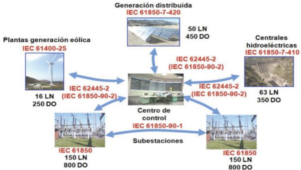
Figura 70 Áreas de aplicación de la norma IEC 61850. Fuente: Comisión Federal de Electricidad [12].
