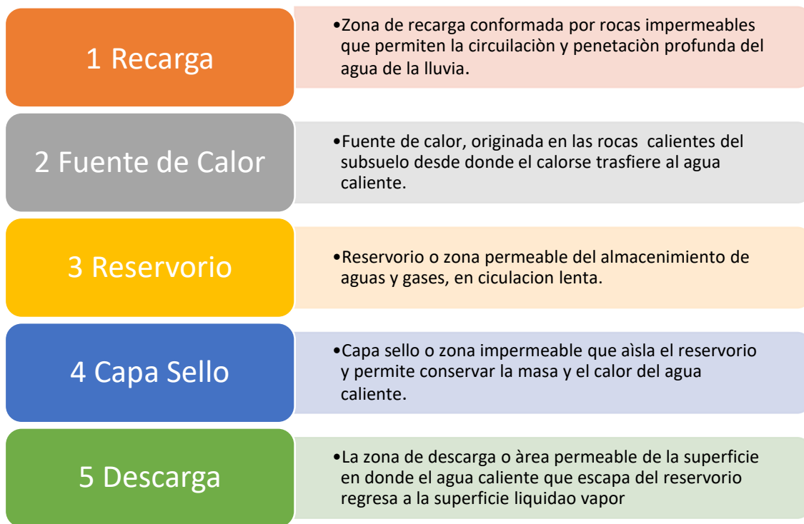
Figura 17 Elementos que definen un campo Geotérmico Convencional. [23]
