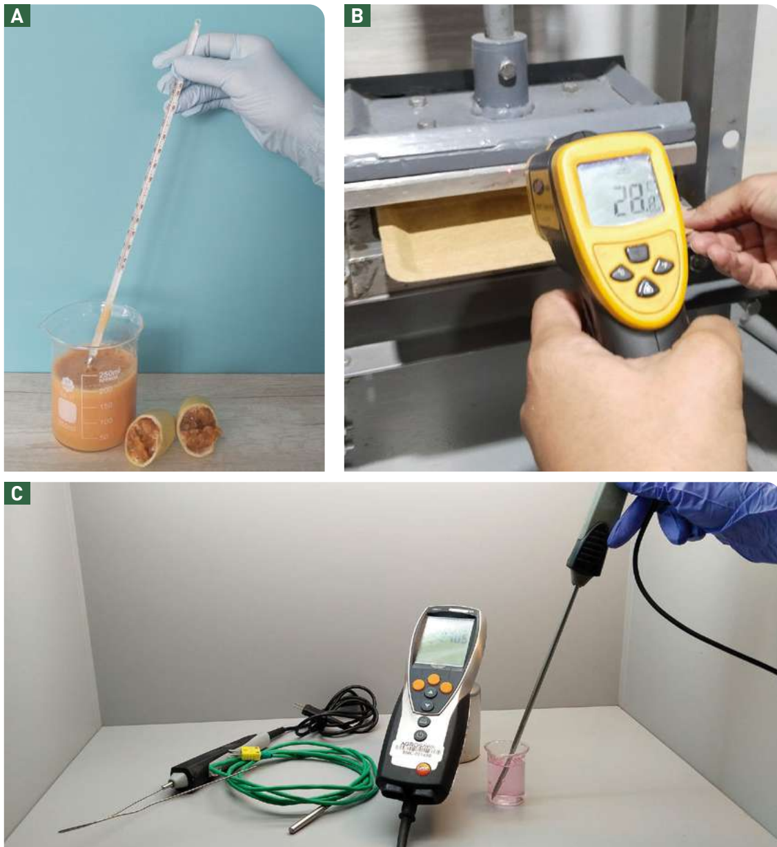
Figura 25. Termómetros. a. De mercurio; b. Infrarrojo; c. Lector con termopar de penetración tipo T y sondas tipo J.
