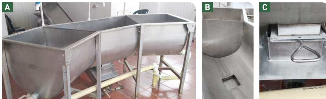
Figura 14. Tanque de lavado, selección y adecuación con tres compartimentos.
