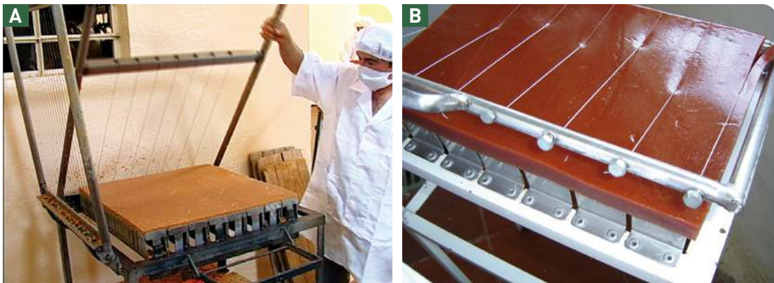
Figura 24. Cortadoras manuales con red de alambres. a. De dos cortes; b. De un corte.
