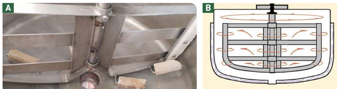
Figura 20. Sistemas de homogenización recomendado para concentración de frutas. a. Sistema de agitación tipo ancla con divisiones y raspadores; b. Esquema de los movimientos de la masa con el agitador tipo ancla.
