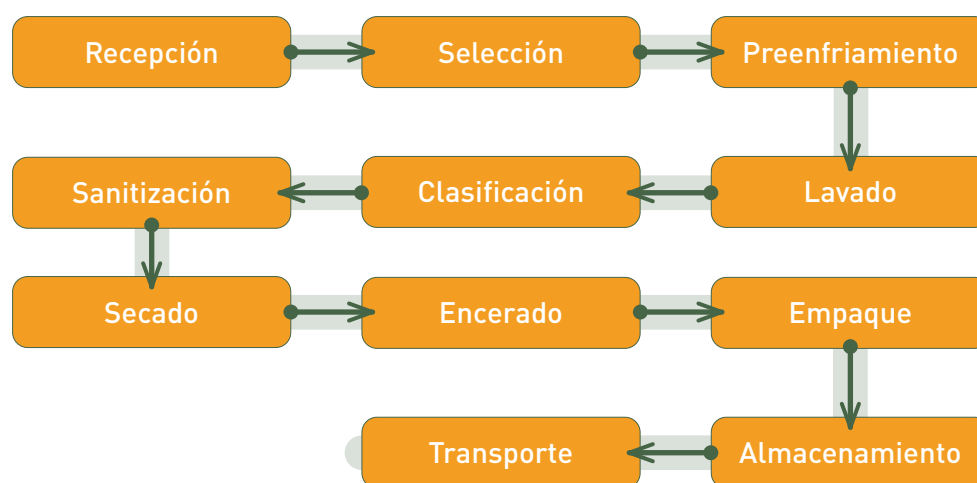
Figura 22. Diagrama de operaciones poscosecha en la cadena de mango.
