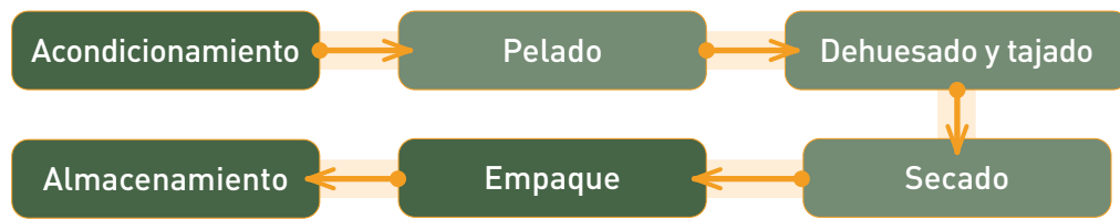
Figura 38. Diagrama de flujo de producción de mango deshidratado.
