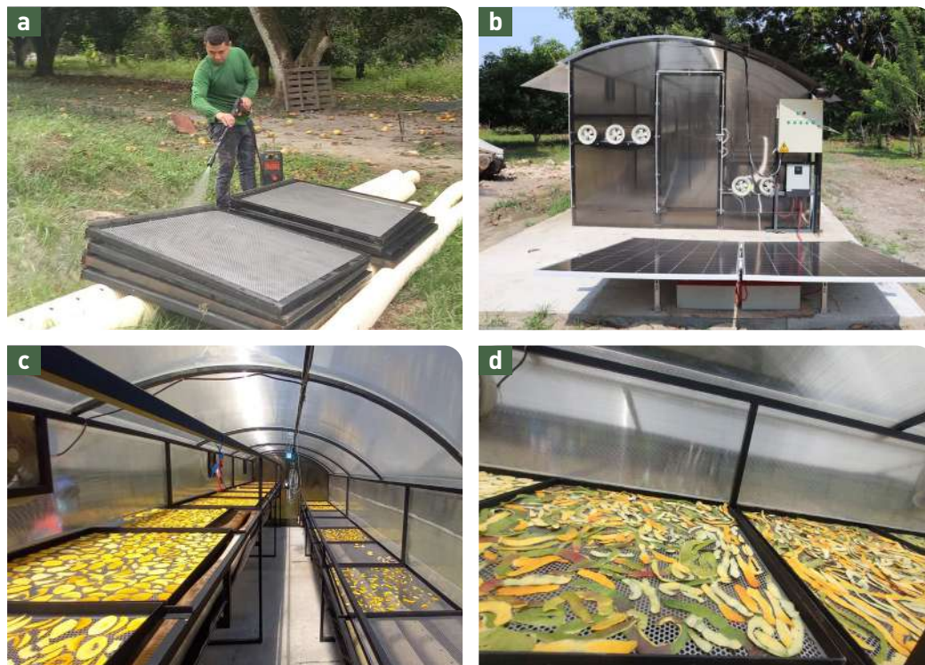
Figura 39. Deshidratador solar de mango con energía solar pasiva y fotovoltaica.
