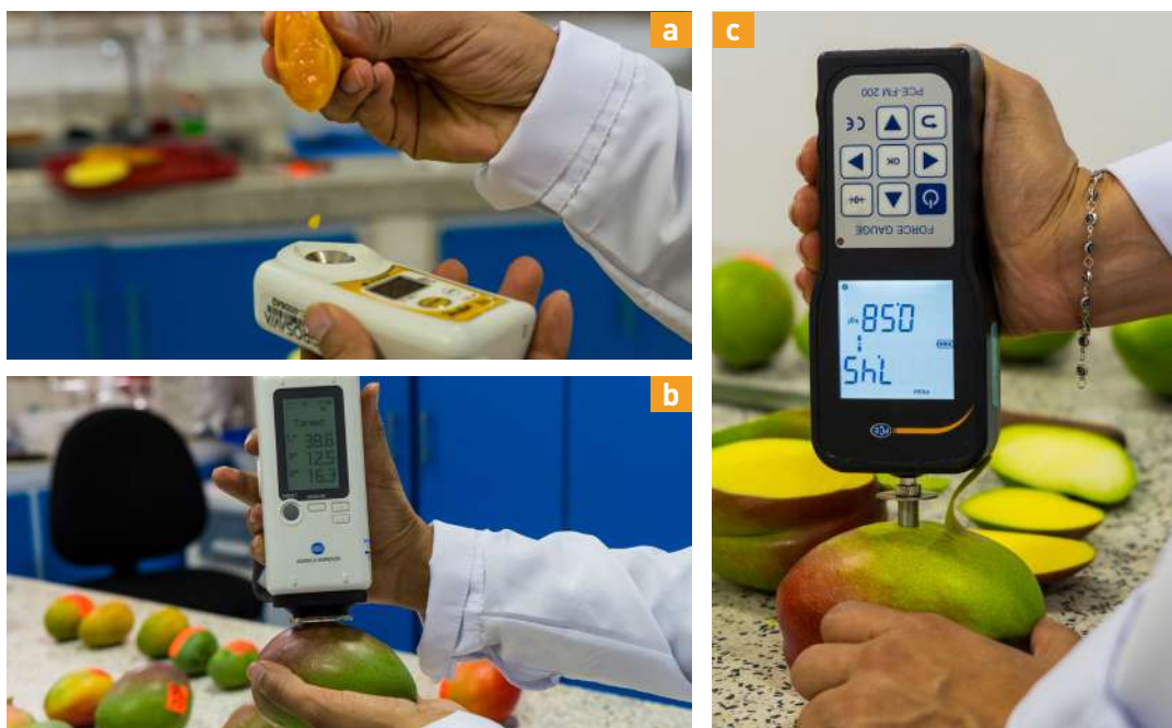
Figura 9. Instrumentos para determinar indicadores de madurez de manera objetiva. a. Medidores de sólidos solubles totales; b. Color; c. Medidores de firmeza.
